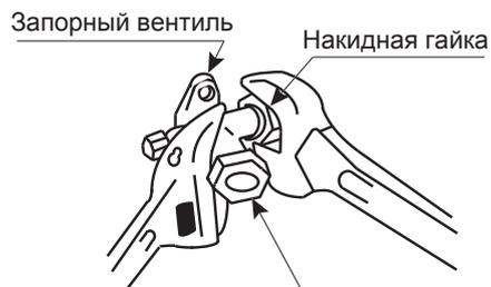
В данном месте соединения, НЕ используйте 2 гаечных ключа, иначе возможна утечка хладагента.
